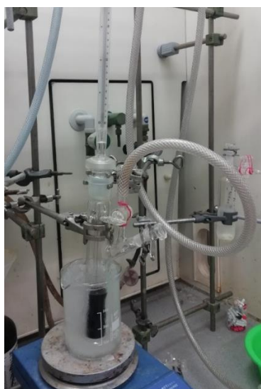
Abbildung 66: Aufbau der Kryoskopieapparatur (links); schematische Darstellung der Apparatur (rechts).
