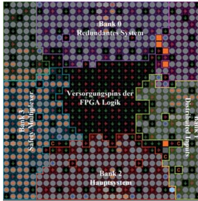
Abbildung 4.3: Trennung der Spannungsversorgung
