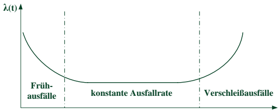
Abbildung 2.3: Ausfallrate \lambda im zeitlichen Verlauf, Quelle: [MP10]
