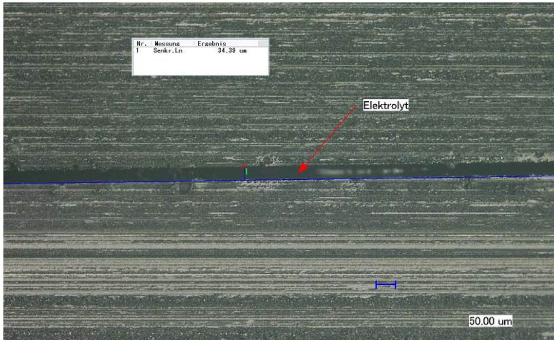
Abbildung 70: Auflichtmikroskopie der Elektrolytschicht im Elektrochromen System
