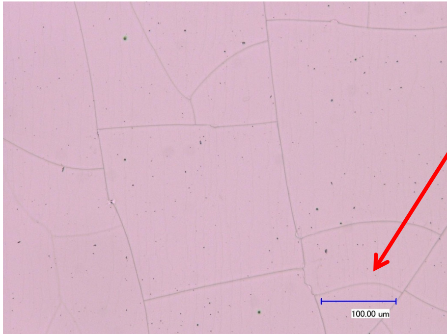
Abbildung 33: PC-ITO bei Umformtemperatur (500-fache Vergrößerung)
