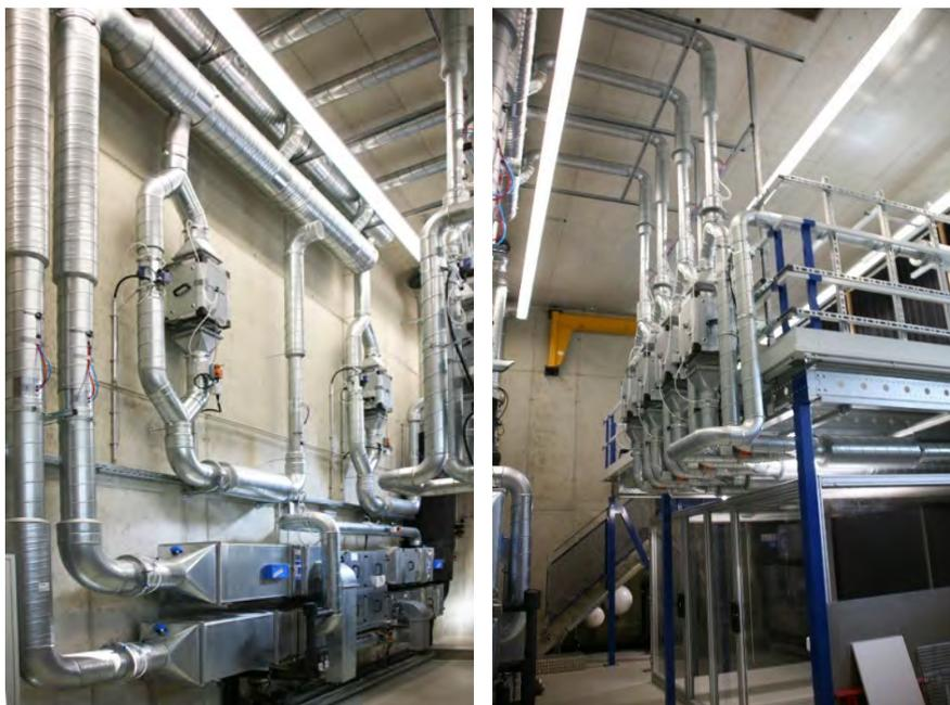
**Abbildung 4: Lüftungsversuchsstand am Fachgebiet Technische Gebäudeausrüstung der Universität Kassel (links das modulare Zentralgerät, rechts die versorgten Testräume).**
