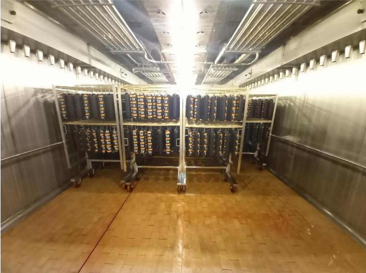
**Foto 12: Vorreifekammer bzw. Räucherammer. Die Reifewägen sind zur Verbesserung der Luftzirkulation nur locker mit Salami bestückt**
