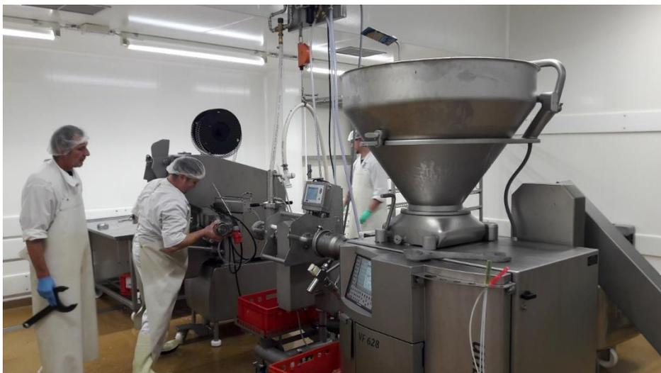
**Foto 11: Füllprozess während des Betriebs mit den in chronologischer Reihe verrohrten Maschineneinheiten - Füllwolf, Metalldetektor mit Ausschleusung und Clipautomat von Poly-Clip**
