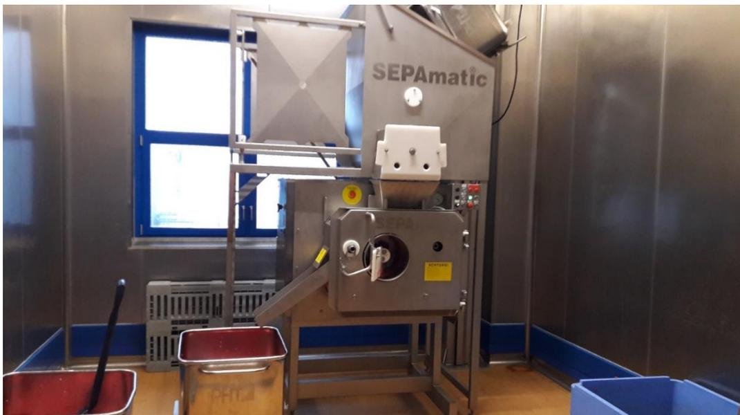
**Foto 09: Entsehnungsmaschine bzw. Bademaschine von SEPAmatic während des Betriebs**
