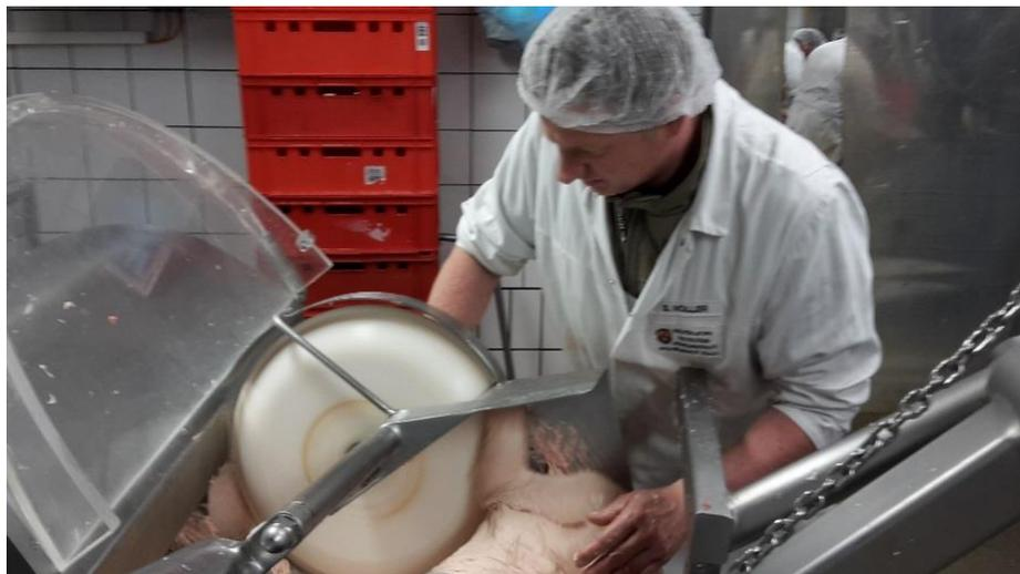
**Foto 03: Spezialvorrichtung für das Ausschleusen des Brühwurstbräts in den Kutterwagen**
