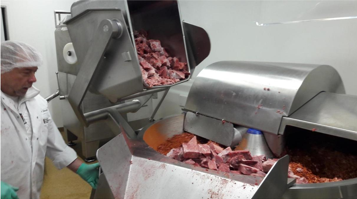
**Foto 10: Rohwurstkutter während des Kutterprozesses bei der Salamiproduktion ohne Zusatzstoffe**
