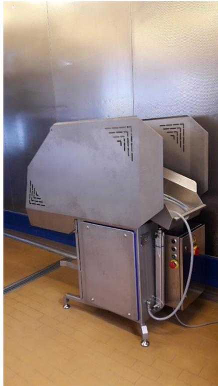
**Foto 08: Gefrierschneider zum Schneiden von Speck bzw. Speckblöcken in Würfeln**
