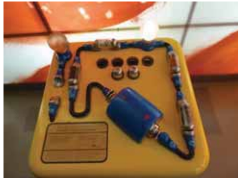
Bild 6: Versuchsaufbau zum Erfahren des Ohm'schen Gesetzes.
