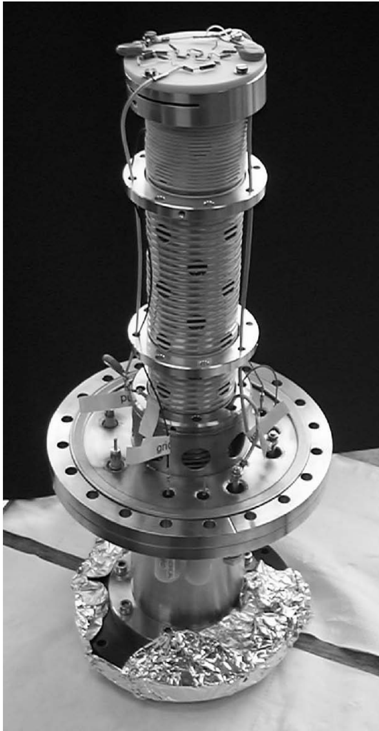
Abbildung A.27: Photo der über den Polplatten sitzenden Driftröhre. Die um die Röhre sich windende 1 mT – Spule ist deutlich erkennbar. Am oberen Ende der Spule ist eine Halterung befestigt, an deren Innenseite der Chevron-MCP montiert ist. Im unteren Bereich ist ein NW150CF Flansch zu sehen, in welchem sich die benötigten Stromdurchführungen befinden. Im Betrieb sitzt montiert auf diesem ein Topf, der sich über einen Bypass zur Hauptkammer evakuieren lässt.
