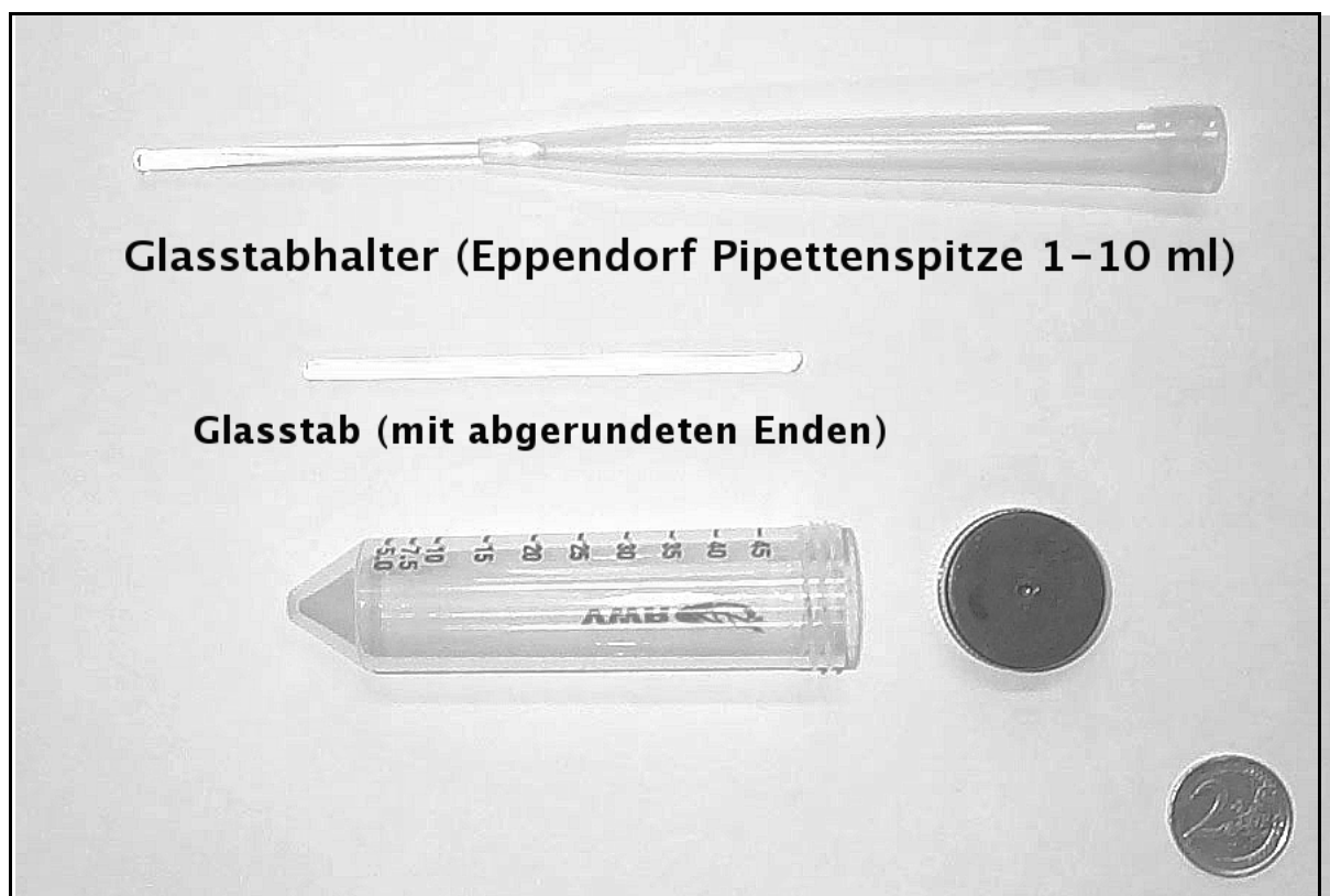
Abbildung 4 Glasstäbe und zugehöriger Halter für das Einweichen des Weizenschrottes bei der Carotinoideanalytik
