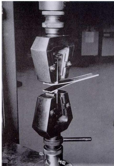
Abbildung 9.1: Versuchsaufbau für die DCB-Probe [34]
