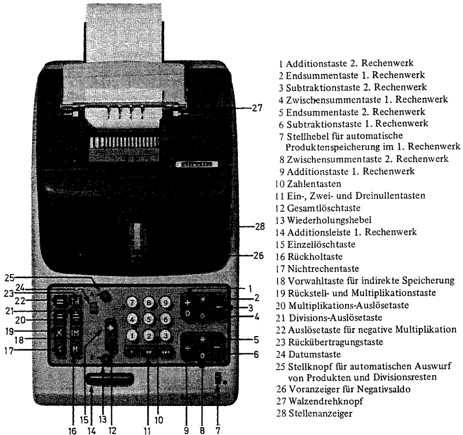
Bild 7: Mechanische Tischrechenmaschine ‚Tetractys‘ der Firma Olivetti
