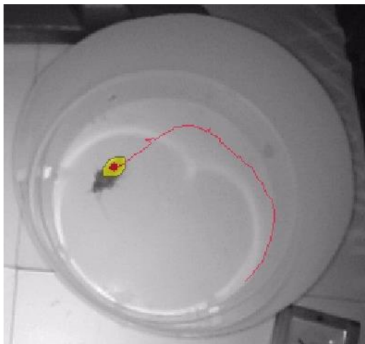
Abb. 14 Laufspur eines Versuchstiers. Das Versuchstier wurde erkannt (gelb) und dessen Bewegung anhand des Körpermittelpunktes (roter Punkt) verfolgt. Der zurückgelegte Weg wird zeichnerisch durch das Programm für einige Sekunden sichtbar gemacht (roter Strich; eigene Aufnahme).
