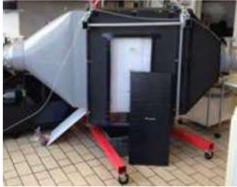
Abb. 6: Plattenwärme- und Stoffübertrager als adiabater Absorber (Smogor 2012)
