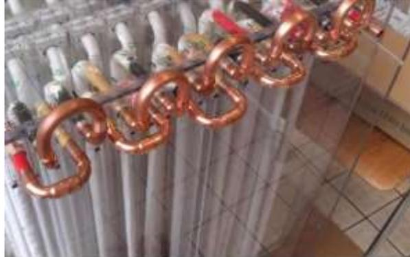
**Abb. 5: Rohrbündelwärme- und Stoffübertrager, Kupferrohre sind beschichtet und zweimal versetzt (Mandow 2014)**
