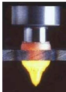
Abbildung 2-5: Farbveränderung beim Thermofließlochformen /28/
