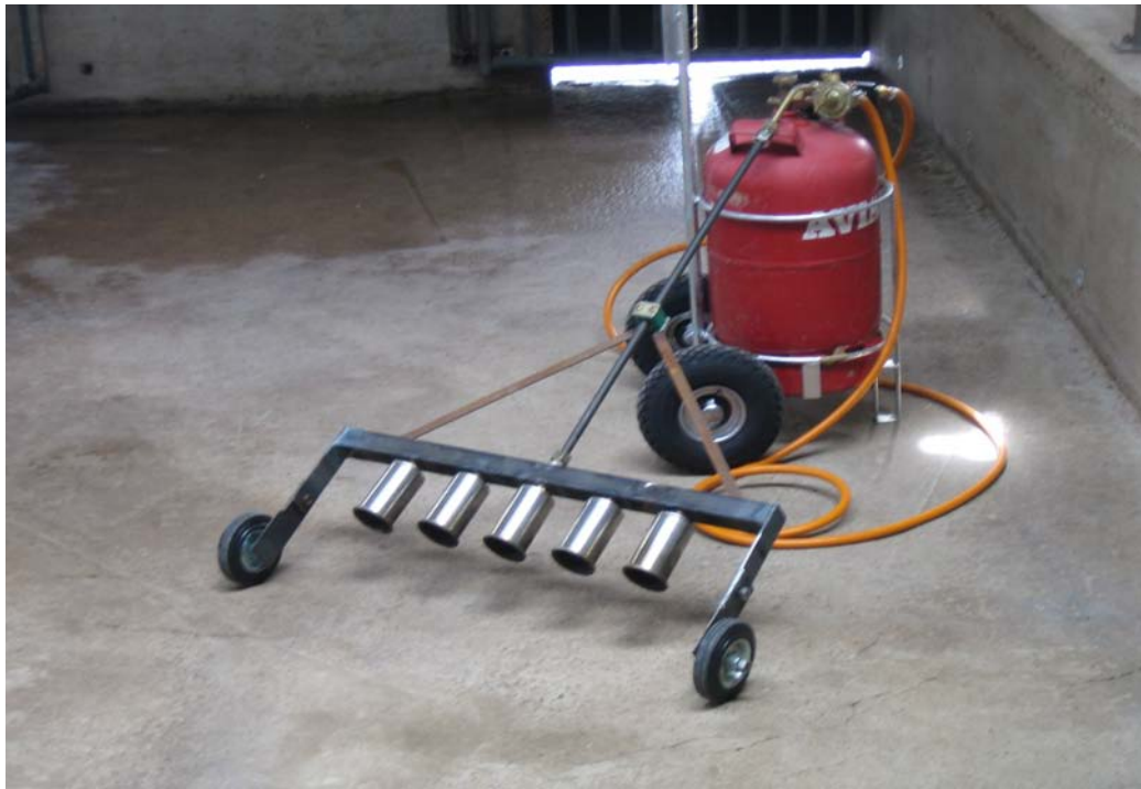
Abbildung 8: selbstgebauter Propangasbrenner auf Betrieb 6
