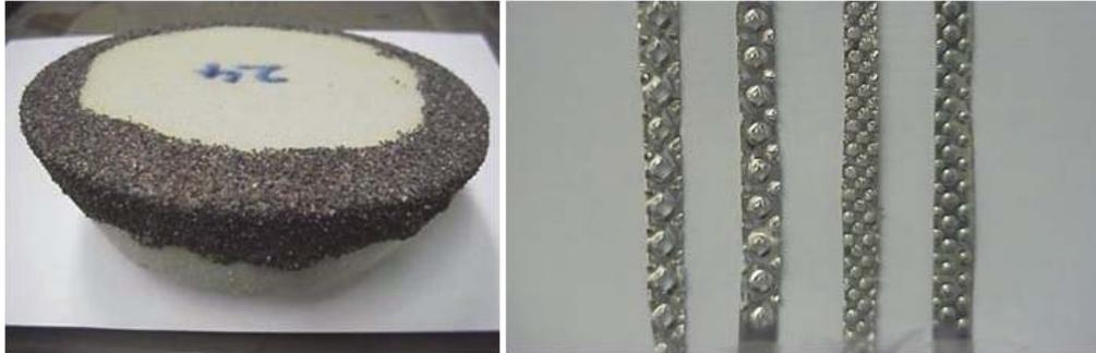
**Abbildung 2.2:** Abrasivdisk und Bürstenstreifen zum Schälen von Kürbissen [Emadi u. a., 2008b, 2007]
