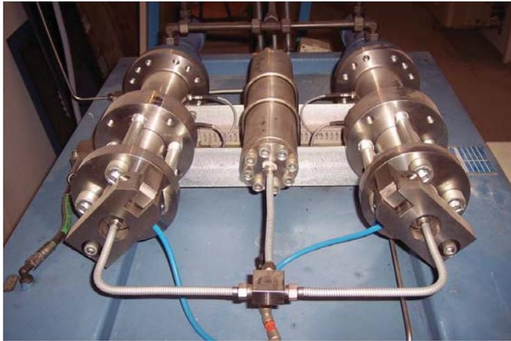
Abbildung 5.2: Druckübersetzer einer Kolbenhochdruckpumpe
