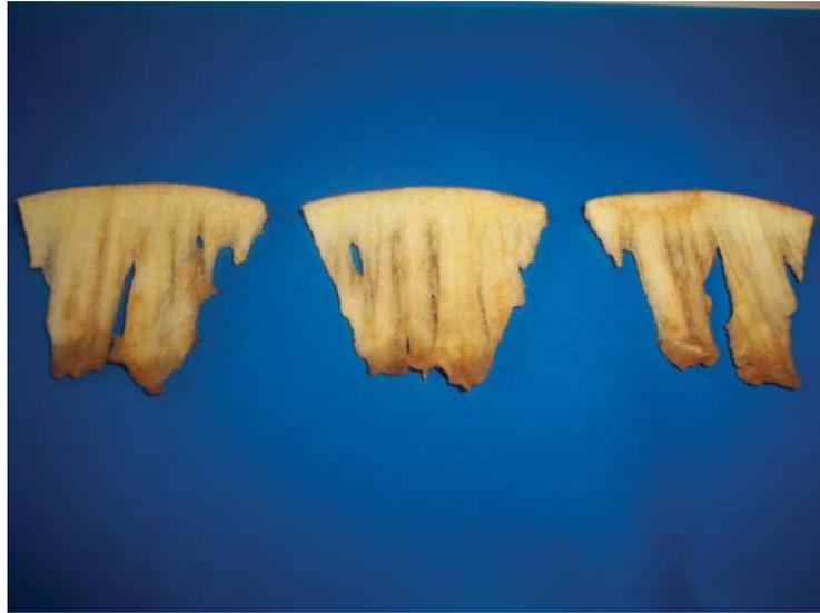
**Abbildung 6.6:** Wasserstrahlschnitt eines Apfels mit Wasserstrahleinstellungen im Übergangsbereich [ $\phi_D = 100\mu m$ ;  $p = 670\text{bar}$ ;  $v = 20\frac{mm}{s}$ ;  $D = 2\text{mm}$ ]
