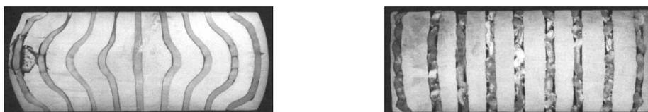
*Abb. 3.1-1:* Deformierter Zylinder beim konventionellen Zylinderstauchversuch (links) und beim RASTEGAEV-Zylinderstauchversuch (rechts) [Reiss und Pöhlandt, 1986]
