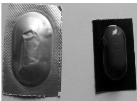
Abbildung 4-6 Untersuchte Blister, links : Aluminium /Aluminiumblister mit Siegelack, rechts : grün eingefärbter PVC- Aluminiumblister; beide Blister mit einer Aluminiumdurchdrückfolie aus einem 3- Lagen Verbund aus BOPA (Biaxial-orientiertem Polyamid – 25 µm), 45 µm gewalztem Aluminium und 60 µm PVC
