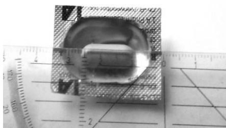
Abbildung 4-14 Visualisierung des Verhältnisses der Abmessungen der Kavität zur Tablette
